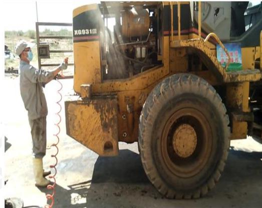
图 7.3.4 吹散热器
