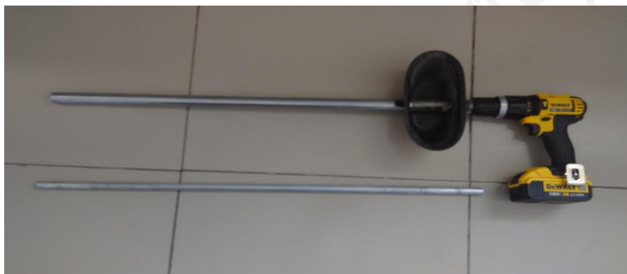
图 9.1.4 干草取样器 (用于成捆或成垛粗饲料样品，包括各类青贮、苜蓿、羊草等常用粗饲料的取样)
