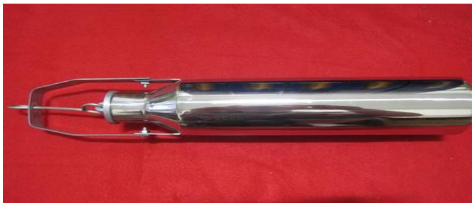
图 9.1.3 液体取样器 (用于液体形态的饲料取样)
